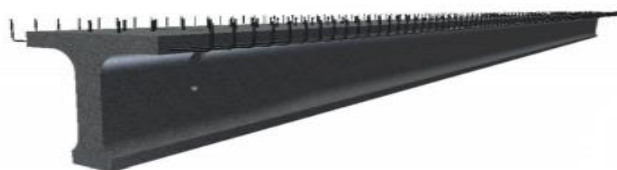
1 Сурет – Алдын-ала кернелген монолитті көпір балкасы
